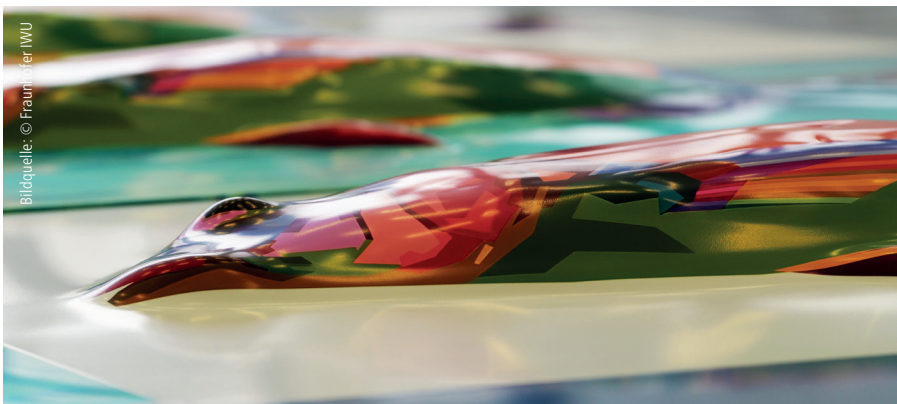
Es können Stahl- und Aluminiumbleche mit Abmessungen von bis zu 4 x 2 Metern und einer „Ausbauchung“ bis zu 75 Zentimetern in nahezu jede Form gebracht werden.
