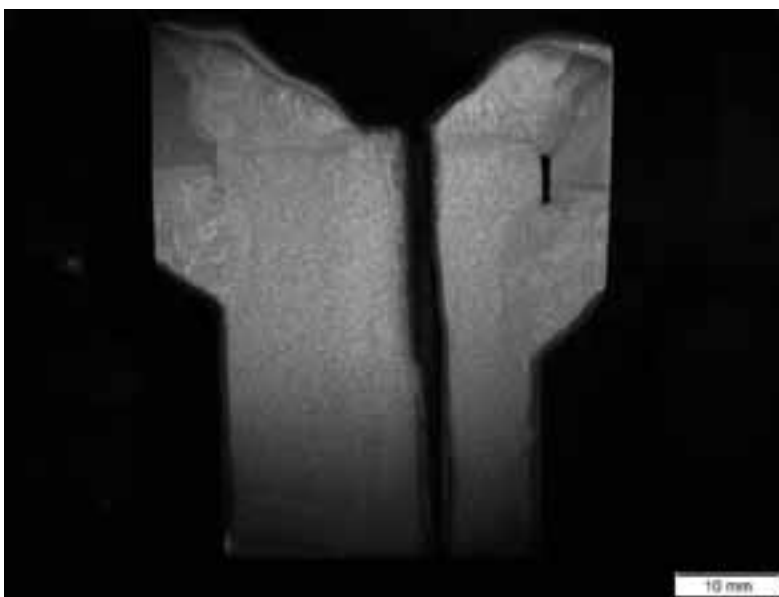
Makroschliff durch eine geschädigte Schweißverbindung, mit Zink gefüllter Riss und Spalt zwischen zwei Fügeteilen.
