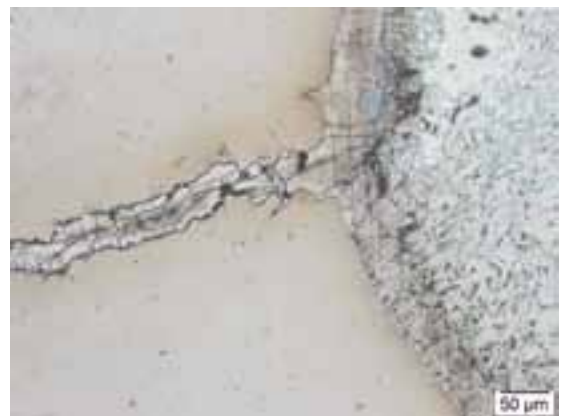
Mikroschliff durch einen mit Zinkphase gefüllten Nebenriss.
